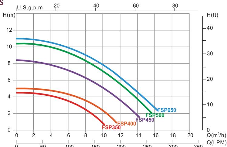
Observación: La curva de rendimiento está basada en el motor 220V/50Hz
