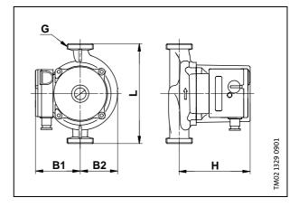
Ligações: Uniões de ¾" e válvulas Pressão da instalação: Máx. 10 Bar
