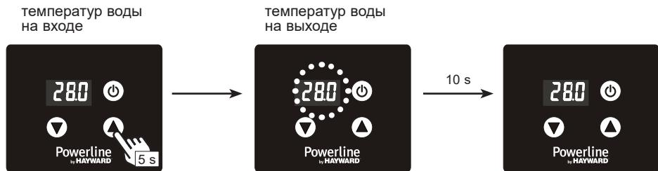
Затем произведите установку перепускного клапана так, чтобы получить разницу в 2 °C между вводом и выводом.
