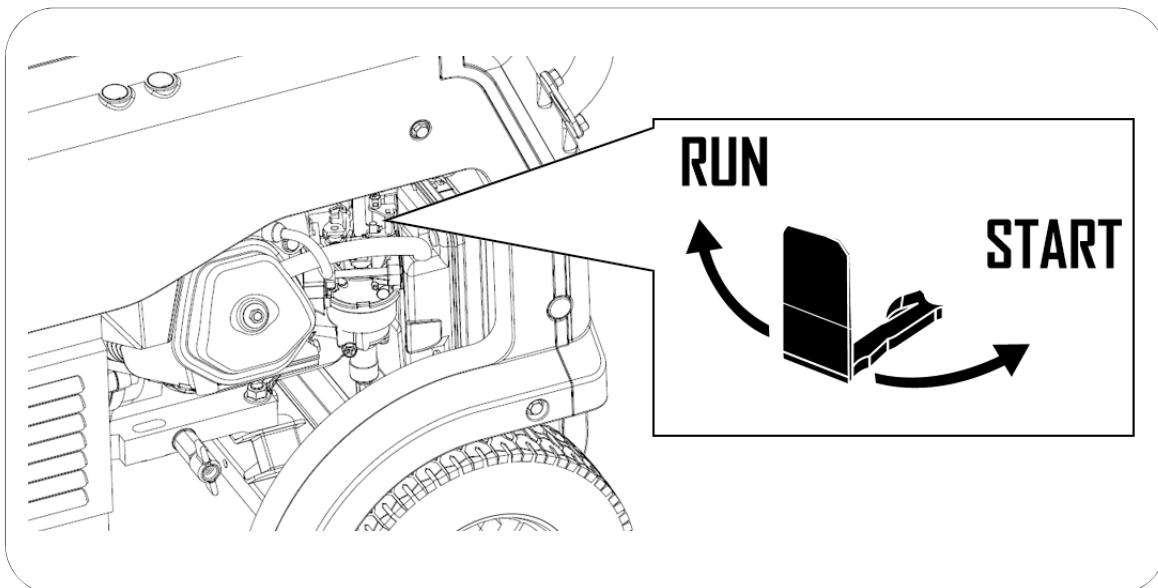
**Informação:** Se o motor deixou de funcionar recentemente e ainda está quente, pode não ser necessário o uso do estrangulador. Neste caso, diretamente, coloca-se na posição **RUN**.
