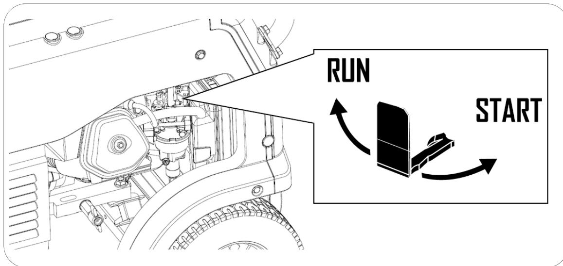
**NOTA:** No mantenga el motor funcionando con el estrangulador en la posición **START** ya que la mezcla sería demasiado rica y provocaría problemas en el motor. Por tanto, tan pronto haya arrancado el motor asegúrese de desplazar a **RUN**.
