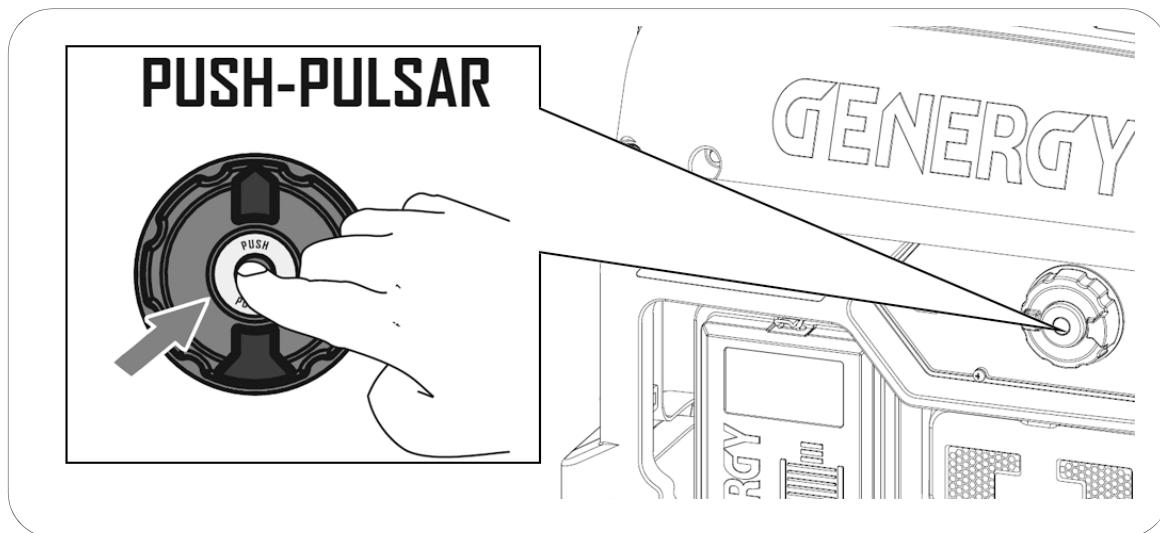
**NOTA:** Si el motor no arranca en 3 o 4 segundos, suelte el botón de arranque y espere unos segundos antes de volver a intentarlo para evitar sobrecalentar el motor de arranque.
