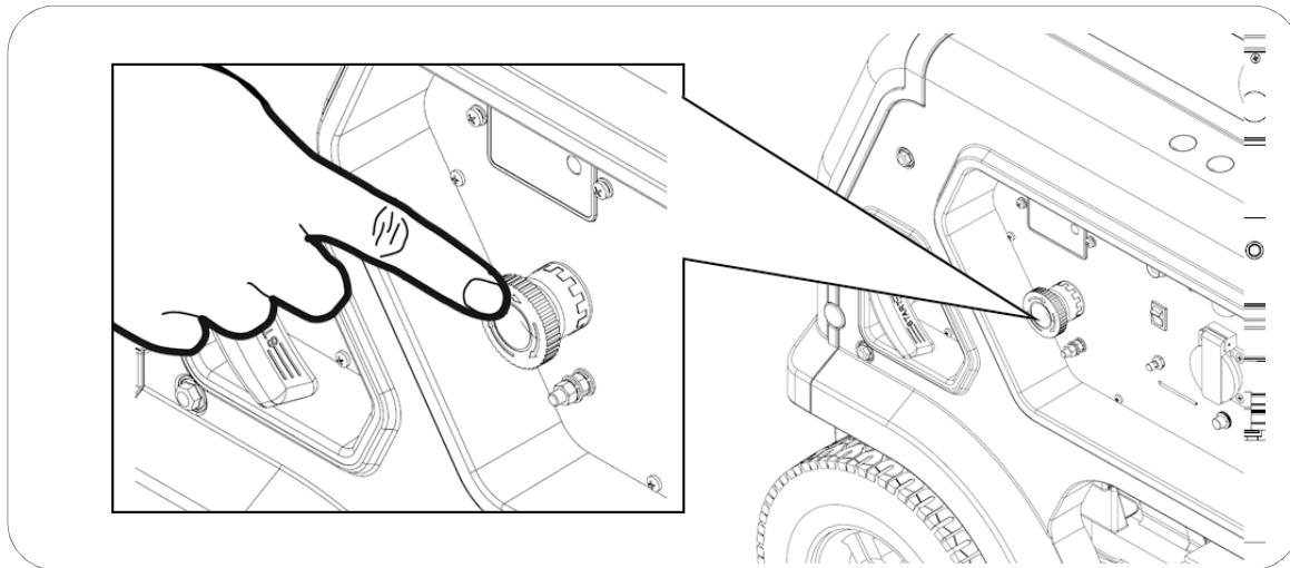
**NOTA:** Utilizar o botão de paragem de emergência apenas quando existe uma situação de risco, caso contrário, desligue o gerador pelo método normal.
