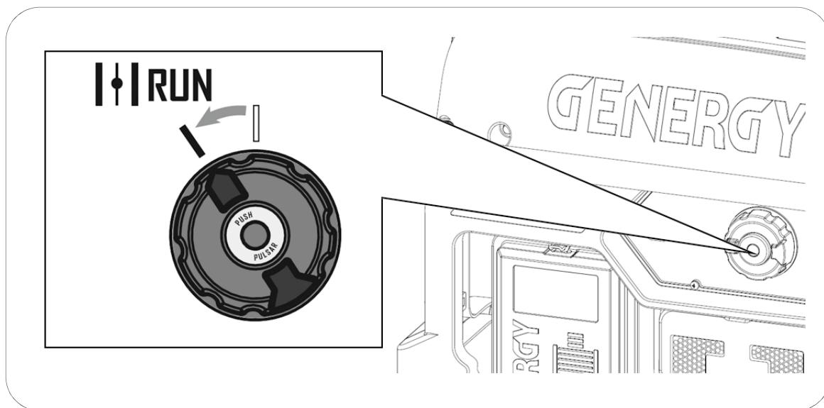
**NOTA:** No mantenga el motor funcionando en la posición **CHOKE** ya que la mezcla sería demasiado rica y provocaría problemas en el motor. Por tanto, tan pronto haya arrancado el motor asegúrese de situar el DIAL en **RUN**
