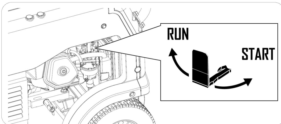
**NOTA:** No mantenga el motor funcionando en la posición **START** ya que la mezcla sería demasiado rica y provocaría problemas en el motor. Por tanto, tan pronto haya arrancado el motor asegúrese de desplazarlo a **RUN**
