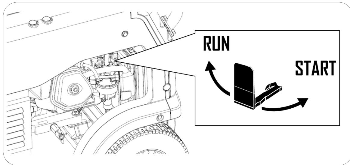
**NOTA:** O motor não deve ser mantido a funcionar com o estrangulador na posição **START**, já que a mistura seria demasiado rica e provocaria problemas no motor. Portanto, logo que tenha arrancado o motor, o utilizador deve assegurar que o estrangulador é movido para a posição **RUN**.
