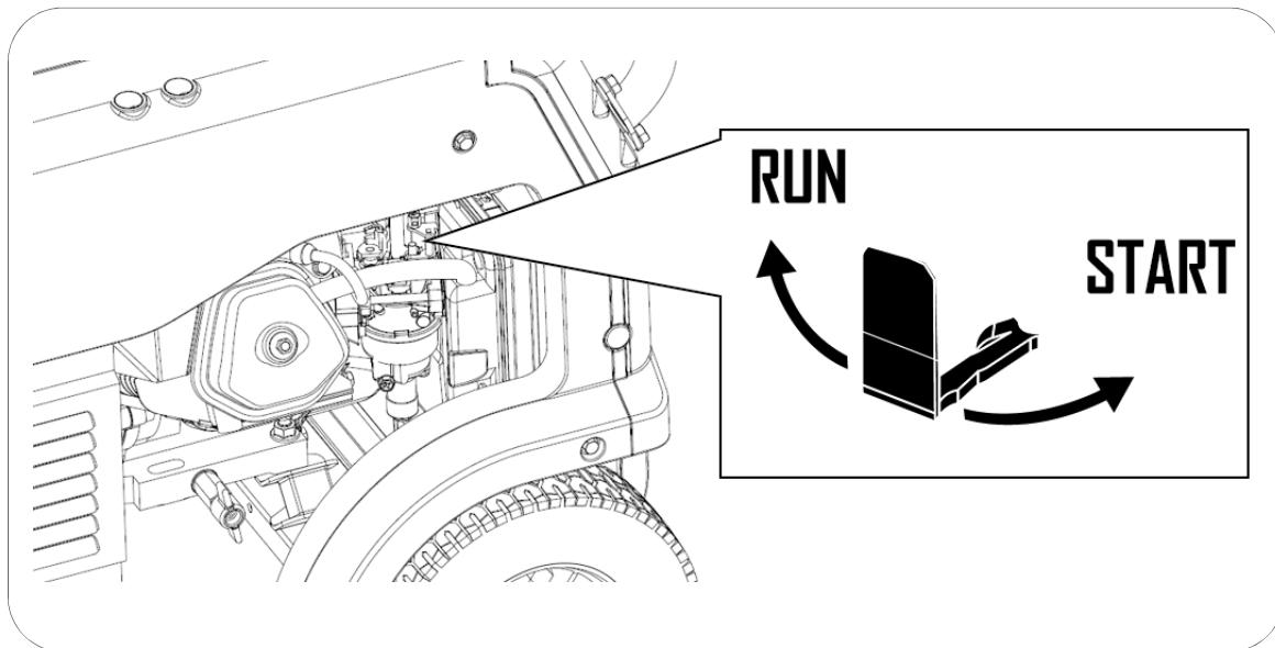
**Información:** Puede no ser necesario el uso del estrangulador si el motor fue detenido recientemente y aún está caliente. En ese caso se situaría directamente en la posición **RUN**
