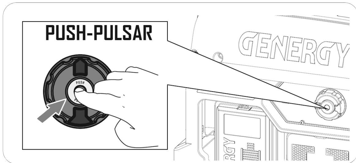
**NOTA:** Se o motor não arrancar em 3 ou 4 segundos, soltar o botão de arranque (DIAL) e esperar alguns segundos para voltar a tentar. Caso contrário, pode sobreaquecer e danificar o motor de arranque.
