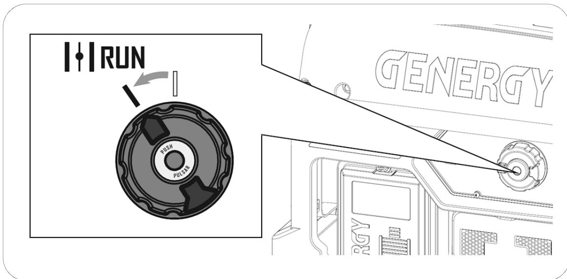
**NOTA:** O motor não deve ser mantido a funcionar na posição **CHOKE**, já que a mistura seria demasiado rica e provocaria problemas no motor. Portanto, logo que tenha arrancado o motor, o utilizador deve assegurar-se de que o DIAL é movido para a posição **RUN**.
