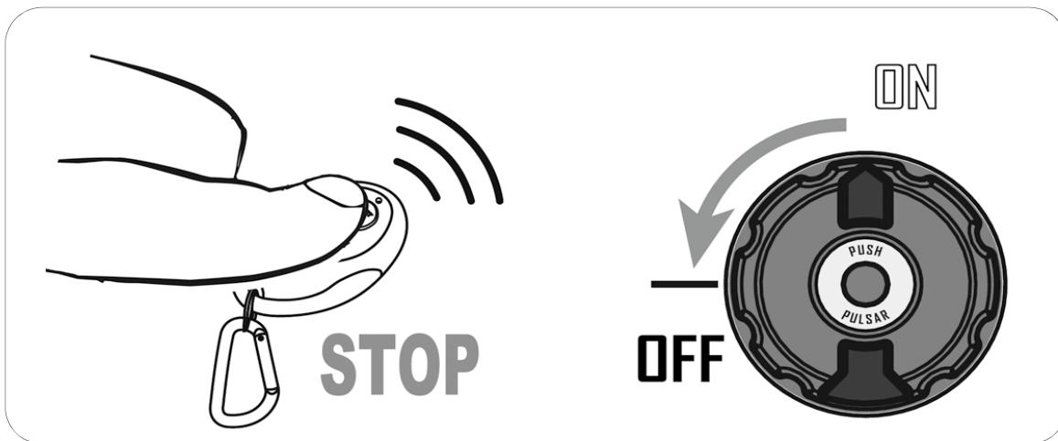
**NOTA:** Salvo uma situação de emergência, não interromper a sequência automática de arranque ou de paragem remota. Aguarde sempre que o processo finalize, antes de voltar a enviar um novo sinal a partir do comando remoto.
