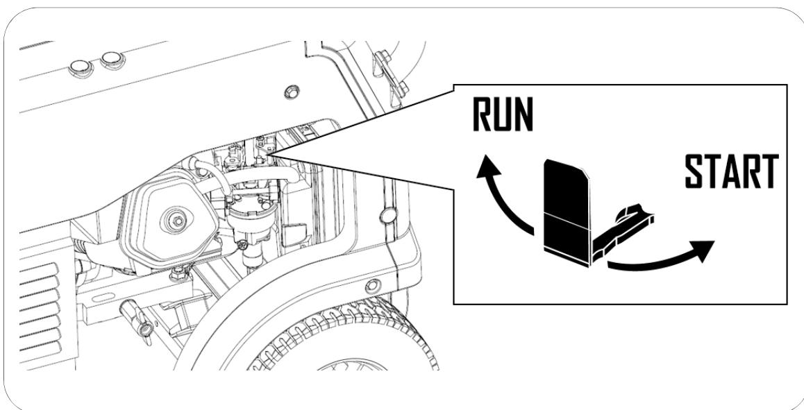
**Información:** Puede no ser necesario el uso del estrangulador si el motor fue detenido recientemente y aún está caliente. En ese caso se situaría directamente en la posición **RUN**
