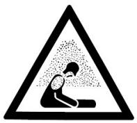
Nunca utilizar o gerador dentro de uma habitação, garagens, túneis, adegas ou qualquer outro lugar sem ventilação.
