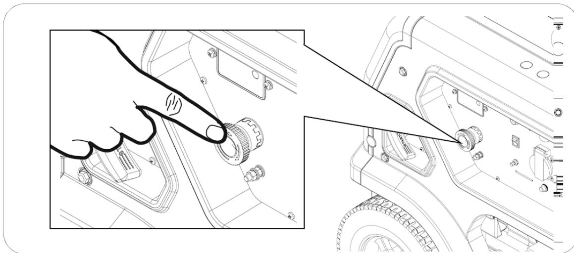
**NOTA:** Utilice el botón de emergencia únicamente cuando exista una emergencia real, caso contrario apague mediante el método normal.
