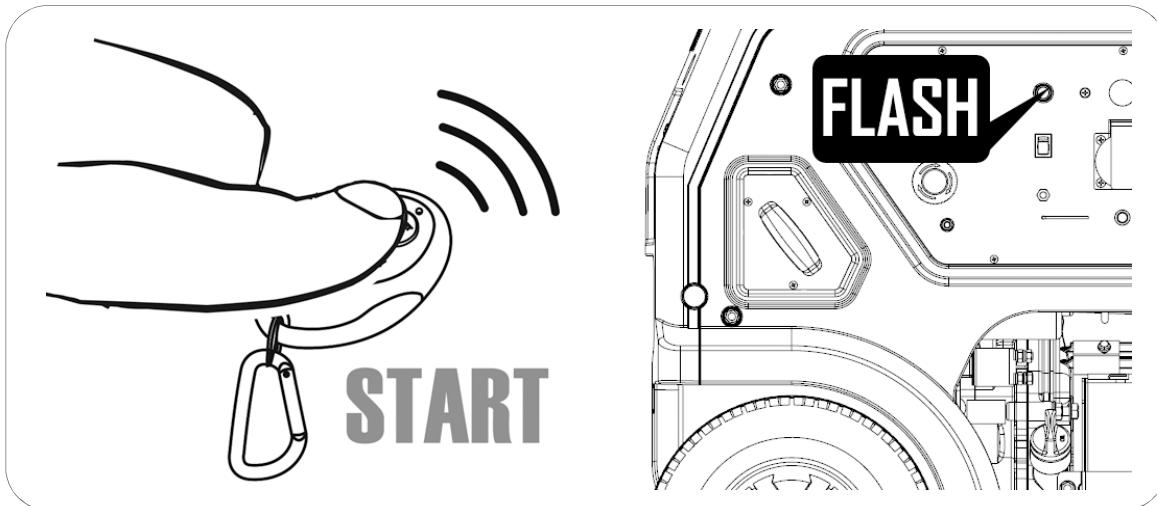
**Informação:** **Função OPD** (Output power delayed). Até 20 segundos após o arranque, o gerador não gera eletricidade para a tomada. Deste modo, assegura-se que o gerador arranca sem equipamentos em carga.
