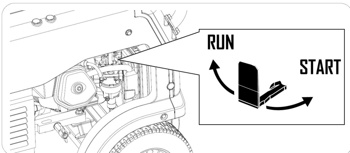
**NOTA:** O motor não deve ser mantido a funcionar com o estrangulador na posição **START**, já que a mistura seria demasiado rica e provocaria problemas no motor. Portanto, logo que tenha arrancado o motor, o utilizador deve assegurar de que o estrangulador é movido para a posição **RUN**.
